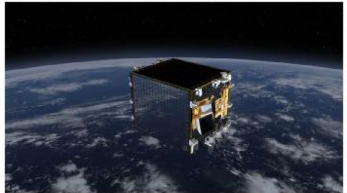
Der europäische Satellit PROBA-V hat auch eine Nutzlast des Deutschen Zentrums für Luft- und Raumfahrt (DLR) mit an Bord: Der Empfänger ortet die ADS-B-Signale (Automatic Dependence Surveillance - Broadcast) von Flugzeugen mit einer speziellen Antenne, während der Trägersatellit in 820 Kilometern Höhe um die Erde kreist.
