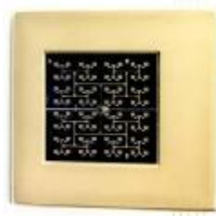
Patchantenne mit elektronischer Strahlsteuerung
